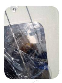
Bei der Erstausrüstung sind alle Fenster mit einer Schutzfolie versehen, um Verarbeitungsspuren zu vermeiden.
