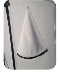
Lüftungshutzen im Heckbereich in der Stb. + Bb. Seite, um ein Über und Unterdruck erzeugen zu können.
