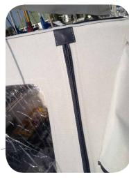
Alle Reißverschlüsse sind durch Abdeckung vor UV-Schädigung geschützt.
