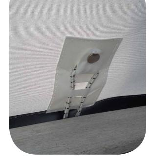
Im Heckbereich bei Anschlußelementen wird mit Spanngummis gearbeitet, um die Montage zu erleichtern.
