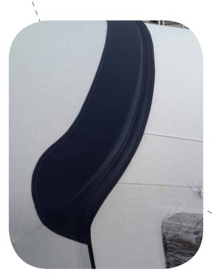
Reißverschlüsse in Anschlußelementen erhalten grundsätzlich eine Abdeckung.
